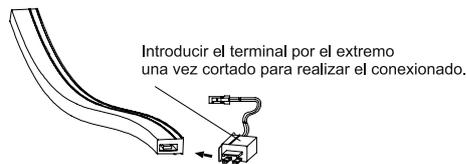
Introducir el terminal por el extremo una vez cortado para realizar el conexionado.
